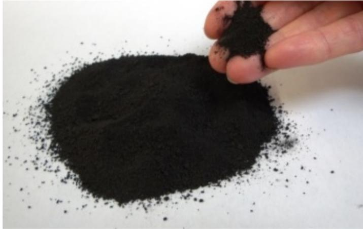
この残渣は、極少量の(未ガス化)炭素分(通常5%以下)と原料に含まれる無機物(K、Na、Ca)の他、更に混入金属(Fe,Cu 他)、ガラス、土石等(金属、ガラス、土石類は非溶解)です。写真の様な無害のクリーンな砂状の固形物です。
